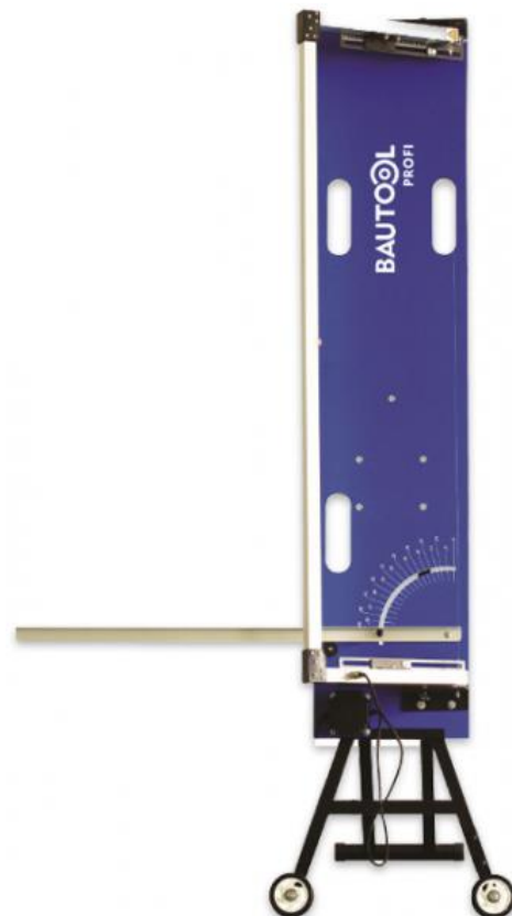
Polisztirol vágó állvánnyal Vágási hosszúság: 1370 mm Vágási magasság: 300 mm Súly: 15 kg CIKKSZÁM: DBD6
